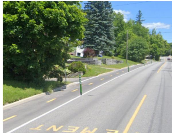
Figure 2.18 Bande cyclable bidirectionnelle, avec délinéateurs (Rue de la Station, Prévost)
