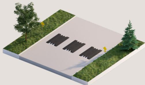
Par sa forme rectangulaire n'occupant pas l'entièreté d'une voie de circulation, le coussin berlinois vise à ralentir la vitesse de circulation des automobiles sans nuire aux déplacements des autres modes de transport, des autobus et des véhicules d'urgence. Contrairement au dos d'âne, il peut être franchi à une vitesse plus élevée (25 à 30 km/h) parce que l'automobile peut avoir une roue sur le coussin et une roue sur la chaussée.
