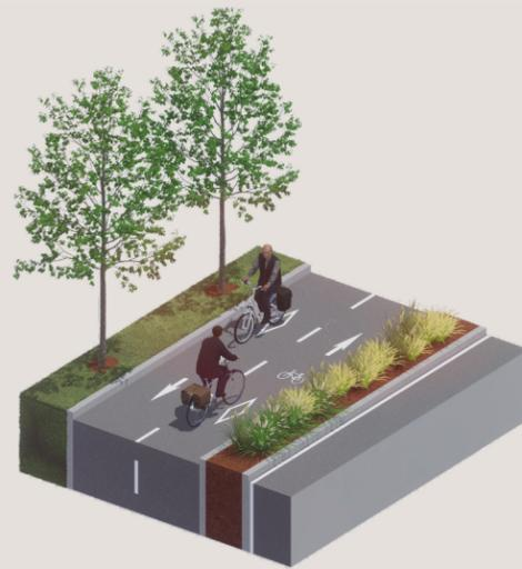
Voie bidirectionnelle réservée aux vélos et séparée physiquement des voies routières par une bordure ou un terre-plein. Elle est implantée d'un seul côté de la rue.
