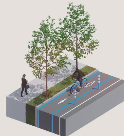
Voie unidirectionnelle réservée aux vélos et séparée physiquement des voies routières des bollards. Elle est implantée de part et d'autre de la rue.
