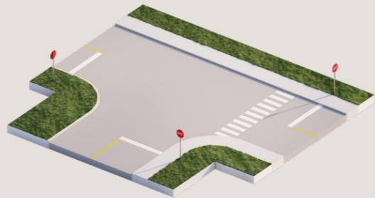
Une bordure à rayon réduit est la modification d'un coin d'intersection pour que celui-ci ait un rayon plus étroit que la norme ordinairement de 3 à 5 mètres.
