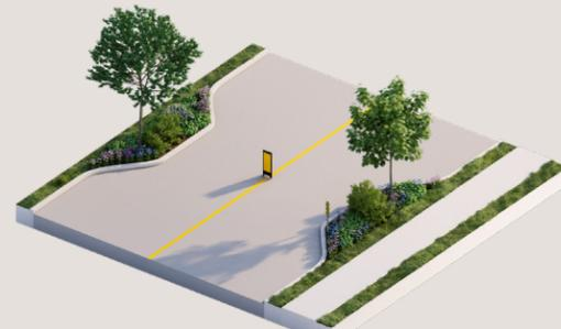
Un goulot d'étranglement est un rétrécissement ponctuel d'une ou de plusieurs voies de circulation grâce à des déviations horizontales implantées au centre de la rue ou sur les côtés de la chaussée. L'expression « goulot d'étranglement » est habituellement réservée aux rétrécissements situés ailleurs qu'aux intersections. Le goulot n'implique pas spécifiquement des traverses pour piétons.
