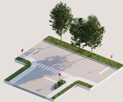
Une saillie de trottoir est un prolongement du trottoir à l'intersection pour rendre les piétons plus visibles et diminuer leur exposition aux collisions en y réduisant la distance de traverse. Une saillie de trottoir peut aussi être utilisée pour réduire la largeur ou le nombre de voies de circulation.
