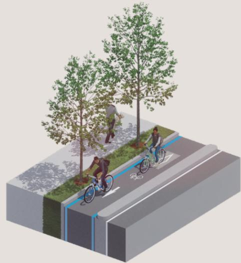
Voie unidirectionnelle réservée aux vélos et séparée physiquement des voies routières et du trottoir par une bordure ou un terre-plein. Elle est implantée de part et d'autre de la rue.
