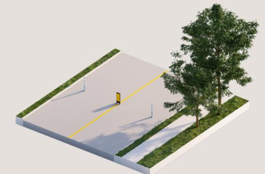
L'installation d'une balise centrale vise un rétrécissement ponctuel de voies de circulation grâce à une implantation au centre de la rue. Cette mesure est normalement installée aux intersections ou à proximité de passage piéton, mais peut également être installée au milieu d'une rue afin d'être complémentaire à d'autres mesures d'apaisement de la circulation. On peut y annoncer la vitesse à respecter ou une obligation de céder le passage aux piétons.
